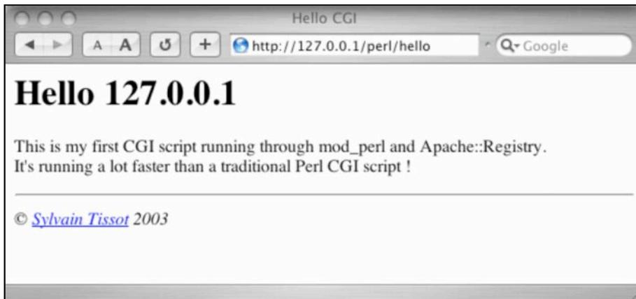
Figure 4.3-9 : appel d'un script CGI au travers de `mod_perl` et `Apache::Registry`
